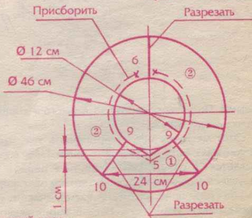
Рис. 1. Размеры для построения чертежа детали юбки "солнце"
